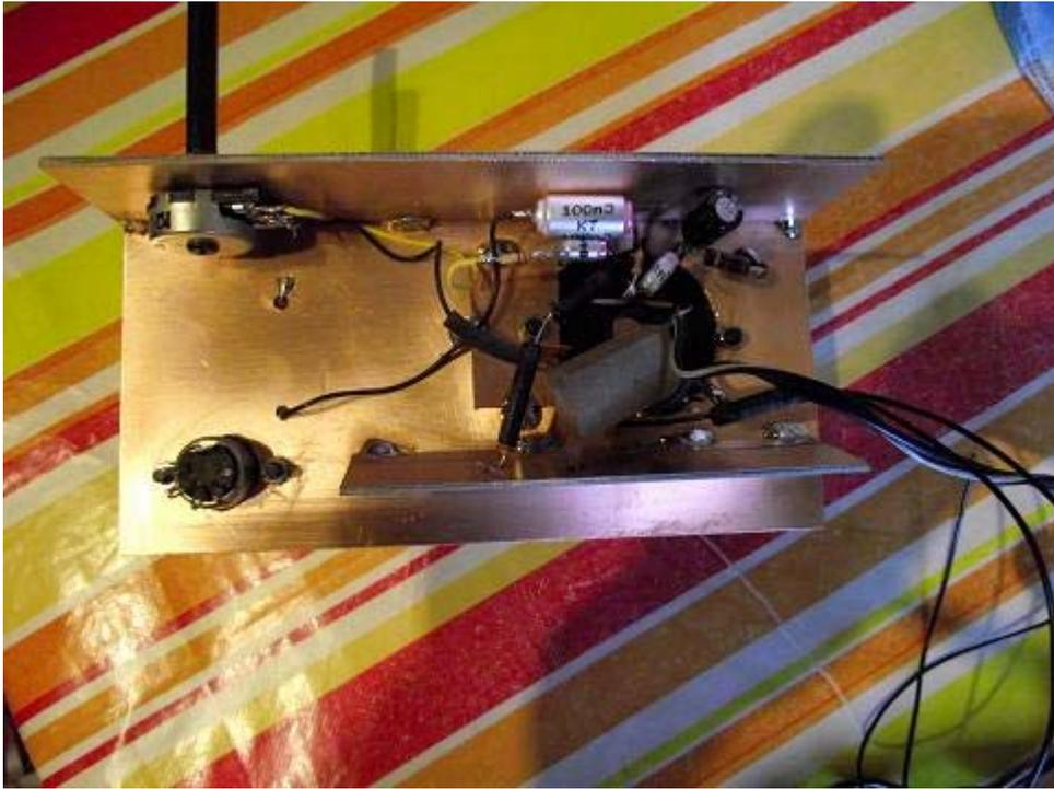
Zu erkennen von unten: 5 POL Din Buchse, Lautstärkereger, sowie die fertig verdrahtete Röhrenfassung.
