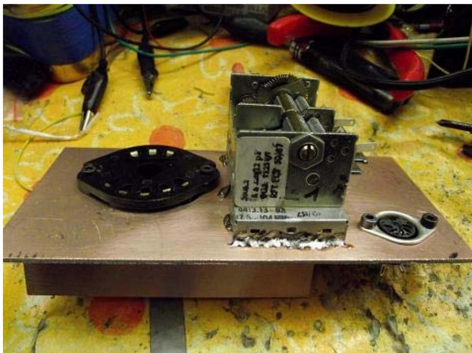
Auf diesem Bild erkennt man die Röhrenfassung, den Drehkondensator, sowie eine Fünfpol Din Fassung für die Spule die auch noch gewickelt werden muss. Unter der Pertinaxplatte ist ein Stück angelötet wo später der Pluspol aufgelegt wird.
