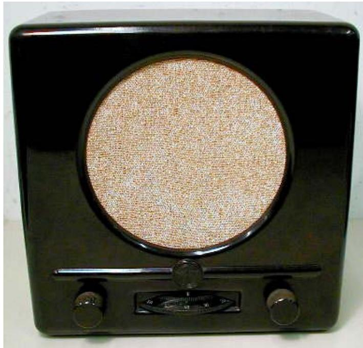
Das Innenleben besteht aus einer Gleichrichter Röhre und einer VCL 11. Heute würde man auch "Null Vau Eins" dazu sagen, ein kleiner Rückkopplungsempfänger (0V1).
