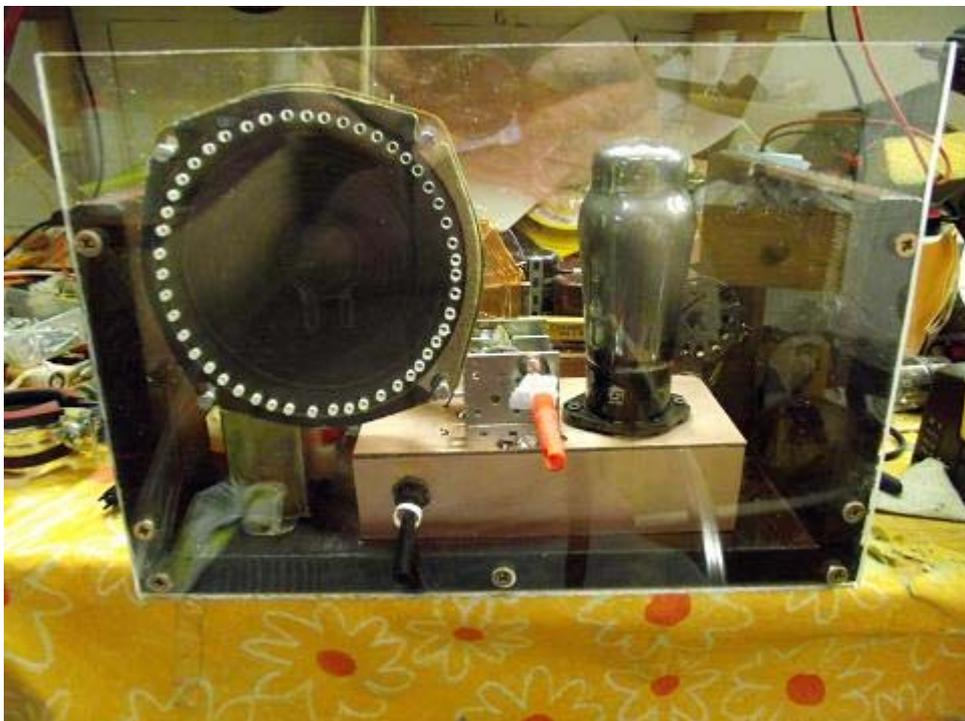
Ohhhhh Schreck – wichtige Bohrungen vergessen! Der zweite Drehkondensator fehlt für die Rückkopplung, sowie die Halterung für das Magische Auge. Also wieder ran ans Werk Front ab ... und Bohren.
